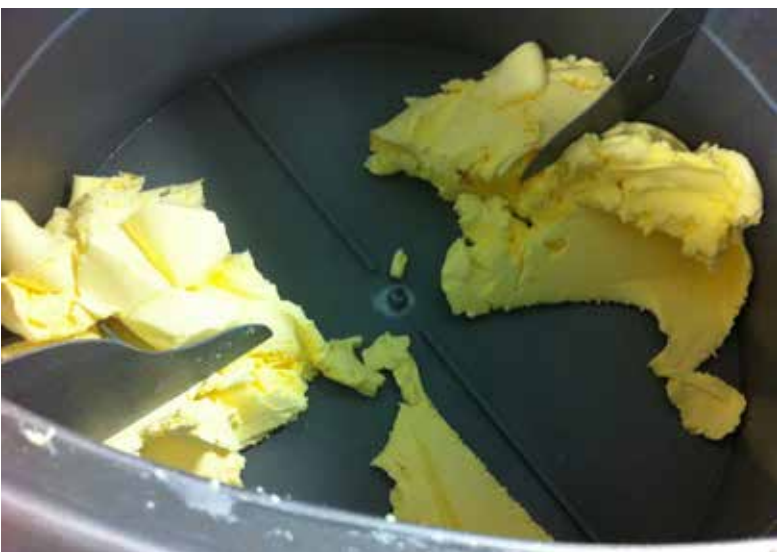
Het kneden van boter in een pasteurisatie-karn-kneder
