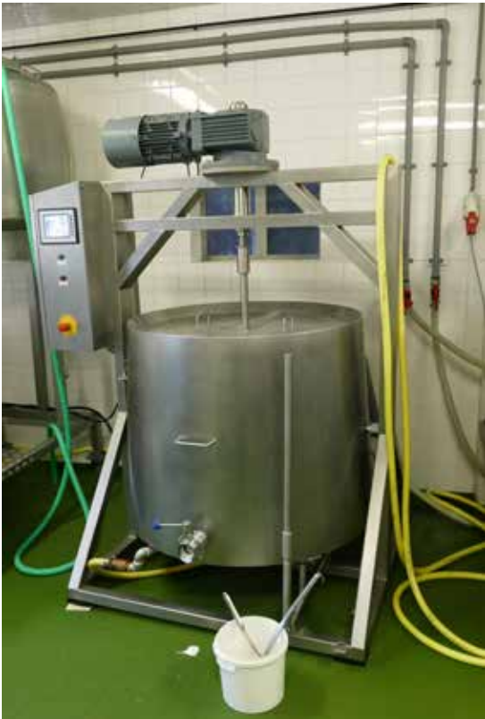
Een staande karn-kneder waarin ook gepasteuriseerd kan worden
